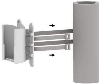
**Paso 3.** Una el radio ensamblado al soporte y deslice como se muestra:
