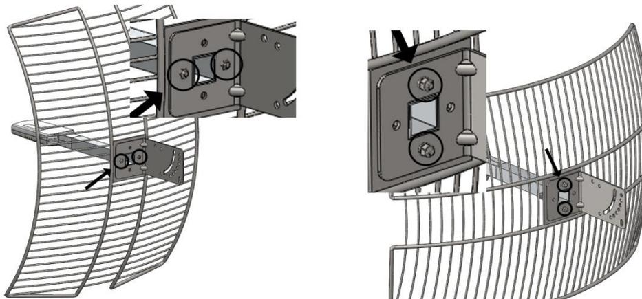
Figura 4 – Polaridad vertical y horizontal de la antena
