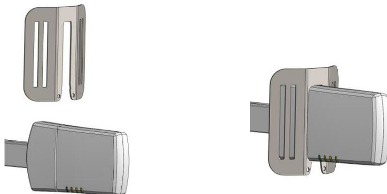
**Paso 3.** Fije la base de la antena a la antena de rejilla (items E y B de *Figura 1 – Contenido del kit del APC 2S-20*) a través de la pieza rectangular y la base de la misma (items C e I de la *Figura 1 – Contenido del kit del APC 2S-20*), utilice los 4 tornillos hexagonales con las protecciones antiderrapantes y tuercas (items M, N, R y O de la *Figura 1 – Contenido del kit del APC 2S-20*).
