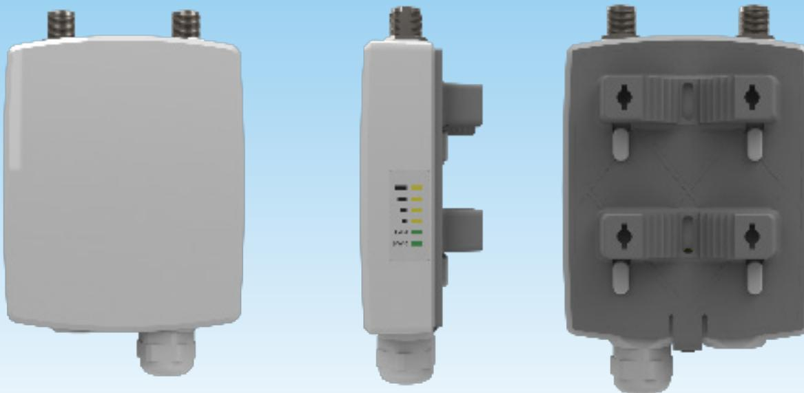
El APC 2M es un equipo extremadamente eficiente y versátil en la banda de 2.4 GHz. Este producto está equipado con un radio de alta potencia (hasta 30 dB) 802.11n con tecnología MIMO con dos conectores tipo N y con cubierta con protección IP-65 lo que lo hace ideal para diferentes opciones de cobertura.
