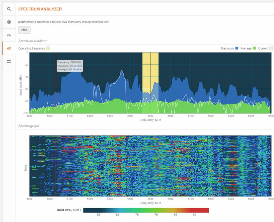
La herramienta de análisis de espectro fue mejorada con el despliegue de un espectrograma. La imagen anterior muestra que existe mucho ruido.
